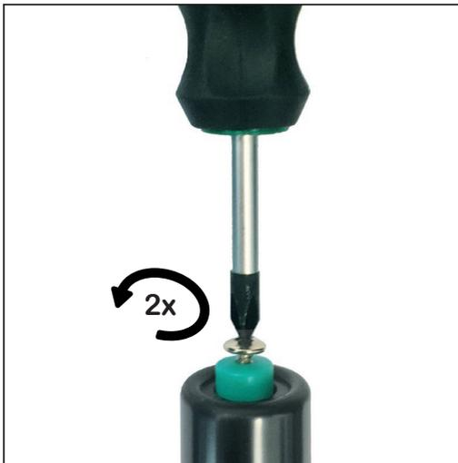
Kreuzschlitzschraube mit dem Kreuzschlitzschraubenzieher zwei Gewindegänge nach links drehen.
